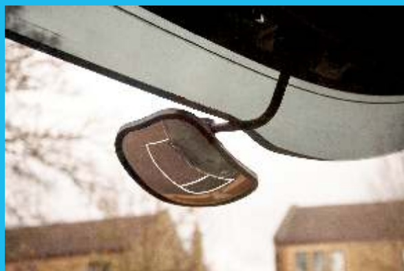
Les lignes blanches indiquent le champ de vision exigé d'un miroir à angle mort avant sur un nouveau modèle de camion.
